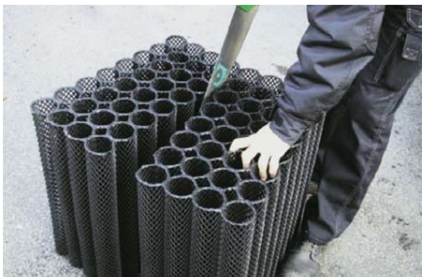
Podział kostki BIO-BLOK® w celu uzyskania większej powierzchni
