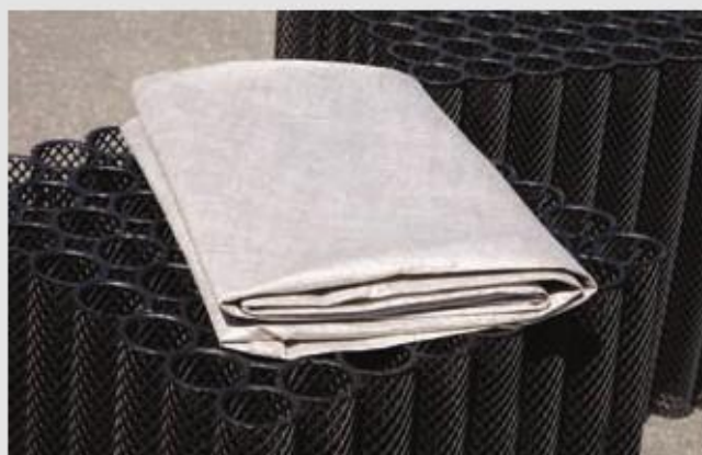
Kostki BIO-BLOK® wykonane są z przyjaznej dla środowiska, polietylenowej siatki, którą zespawano ze sobą na kształt wydrążonych tub. Całość owija się geowłókniną, by zabezpieczyć materiał przed ziemią i innymi cząstkami.
